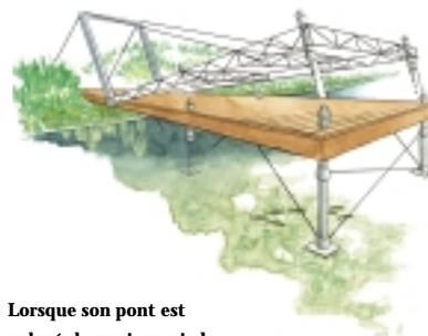
Lorsque son pont est enlevé, le quai sur pieds tubulaires levant peut tout simplement être monté au treuil dans les airs pour échapper aux dommages causés par la glace hivernale.
