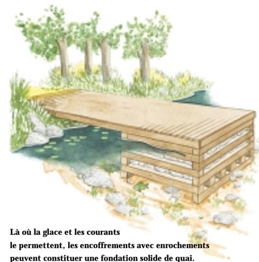
Là où la glace et les courants le permettent, les encoffrements avec enrochements peuvent constituer une fondation solide de quai.
